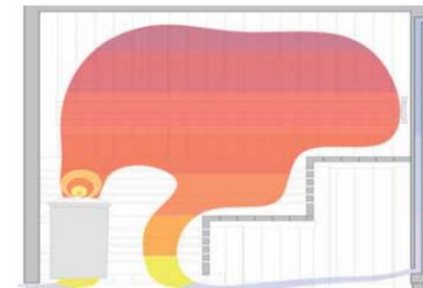
**Ventilazione:** Sistema OVS è in grado di integrare un ricambio ottimizzato e continuo dell'aria, con un ricircolo che omogeneizza le temperature all'interno della cabina
